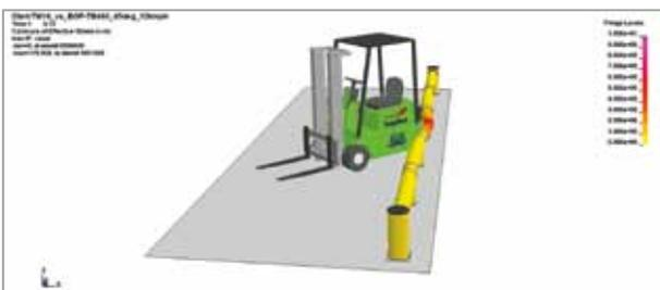
Die Crashtests wurden gegen verschiedene Geschwindigkeiten gemacht und in verschiedenen Aufprallwinkeln. Der Kollisionsschutz überlebte jedes Mal die Stöße und auch der Stapler blieb in einer sicheren Position nach jedem Einschlag.
